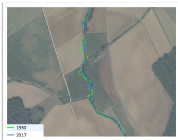
Figure 2 – Exemple rectification sur le ruisseau d'Echalonge à l'aval de Poyans
